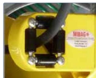
Guidage de rouleaux quadruple stable
