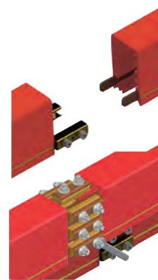
Montage de la pince de raccordement Cu-S
